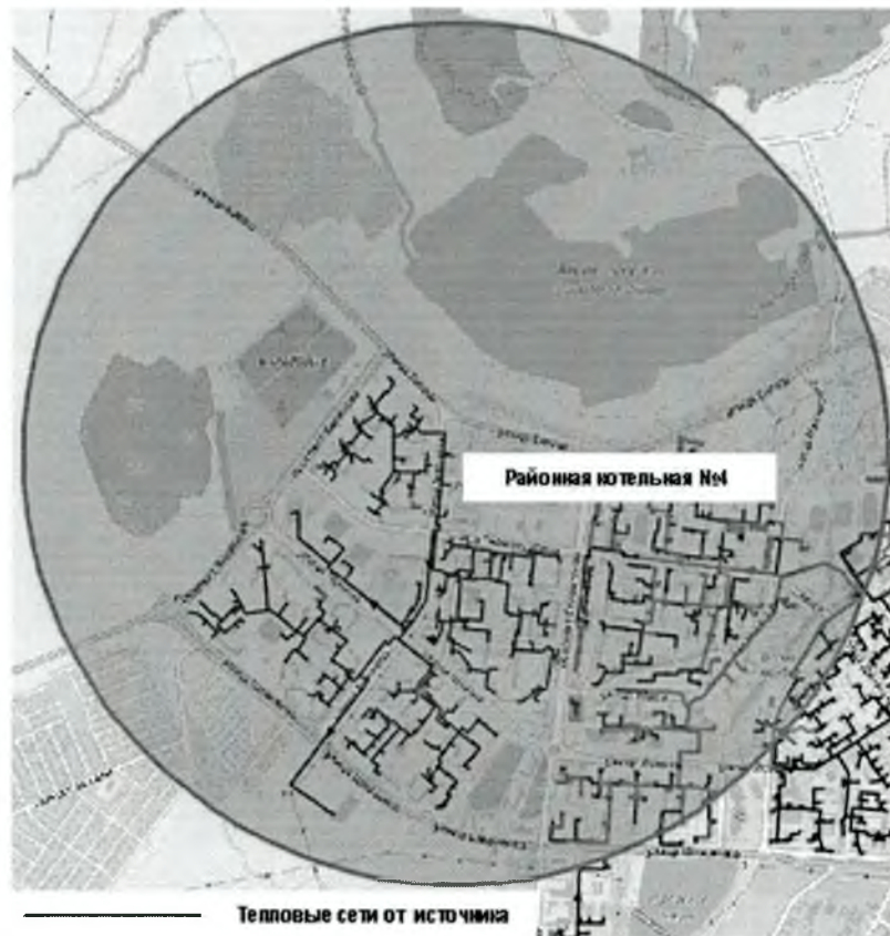
Рисунок 41 Радиус эффективного теплоснабжения квартальной котельной №АО АПТС
