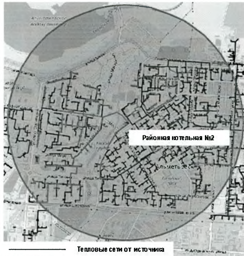
Рисунок 39 Радиус эффективного теплоснабжения квартальной котельной №3 АО АПТС
