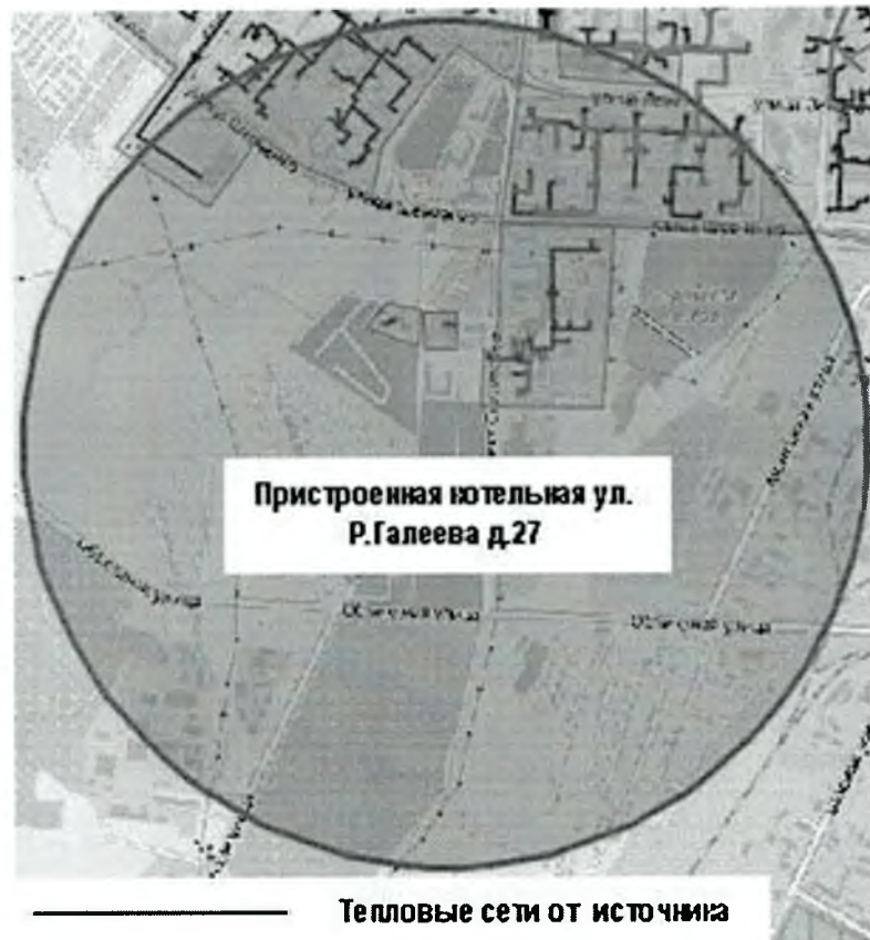
Рисунок 57 Радиус эффективного теплоснабжения пристроенной котельной по ул. Галеева д. 29 ООО УК Алсу2
