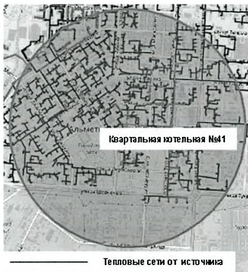
Рисунок 32 Радиус эффективного теплоснабжения квартальной котельной
