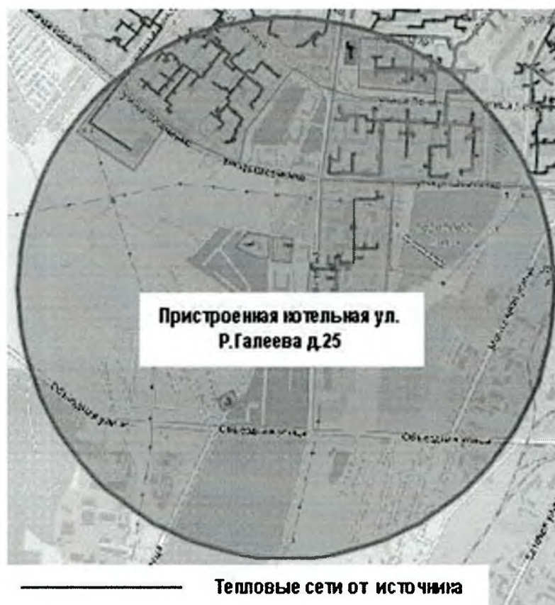
Рисунок 56 Радиус эффективного теплоснабжения пристроенной котельной по ул. Галеева д. 27 ООО УК Алсу2
